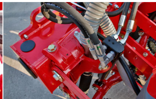
Fixation des rangs par un système de mâchoire pour un changement facile de configuration de 12 à 8 rangs ainsi que du système hydraulique de gestion de la pression de l'élément semeur monté de série
