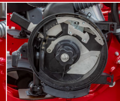
Le sélecteur entraîne la graine dans le tube de descente sans influence des forces centrifuges.
