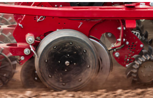
Soc double disque lourd pour une usure limitée et un meilleur contrôle de la profondeur
