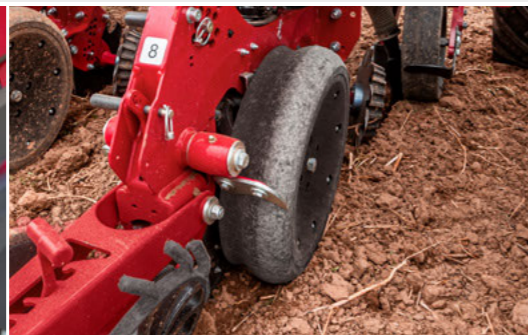
Roue de terrage RID limitant la compaction de la ligne de semis, adaptée aux conditions très difficiles ou au semis direct
