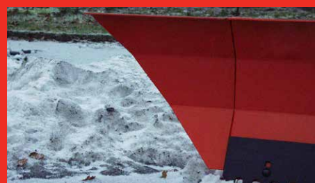
Ailerons à neige est optimale pour le déneigement. Un angle est formé sur la bordure et empêche une accumulation derrière la lame.
