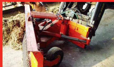
Vérin télescopique qui permet un angle de travail jusqu'à 35 degrés sur la série GT-FL.
