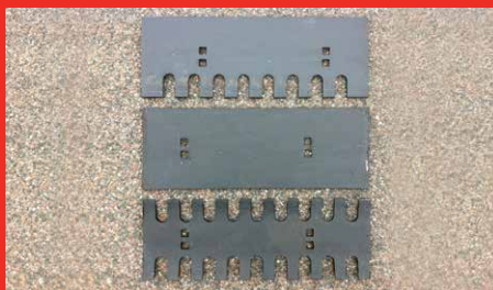
Lame d'usure réversible disponible en trois modèles : lisse/dentelée (de série), lisse/lisse, dentelée/dentelée ; toutes les lames sont en acier trempé, résistante à l'usure.
