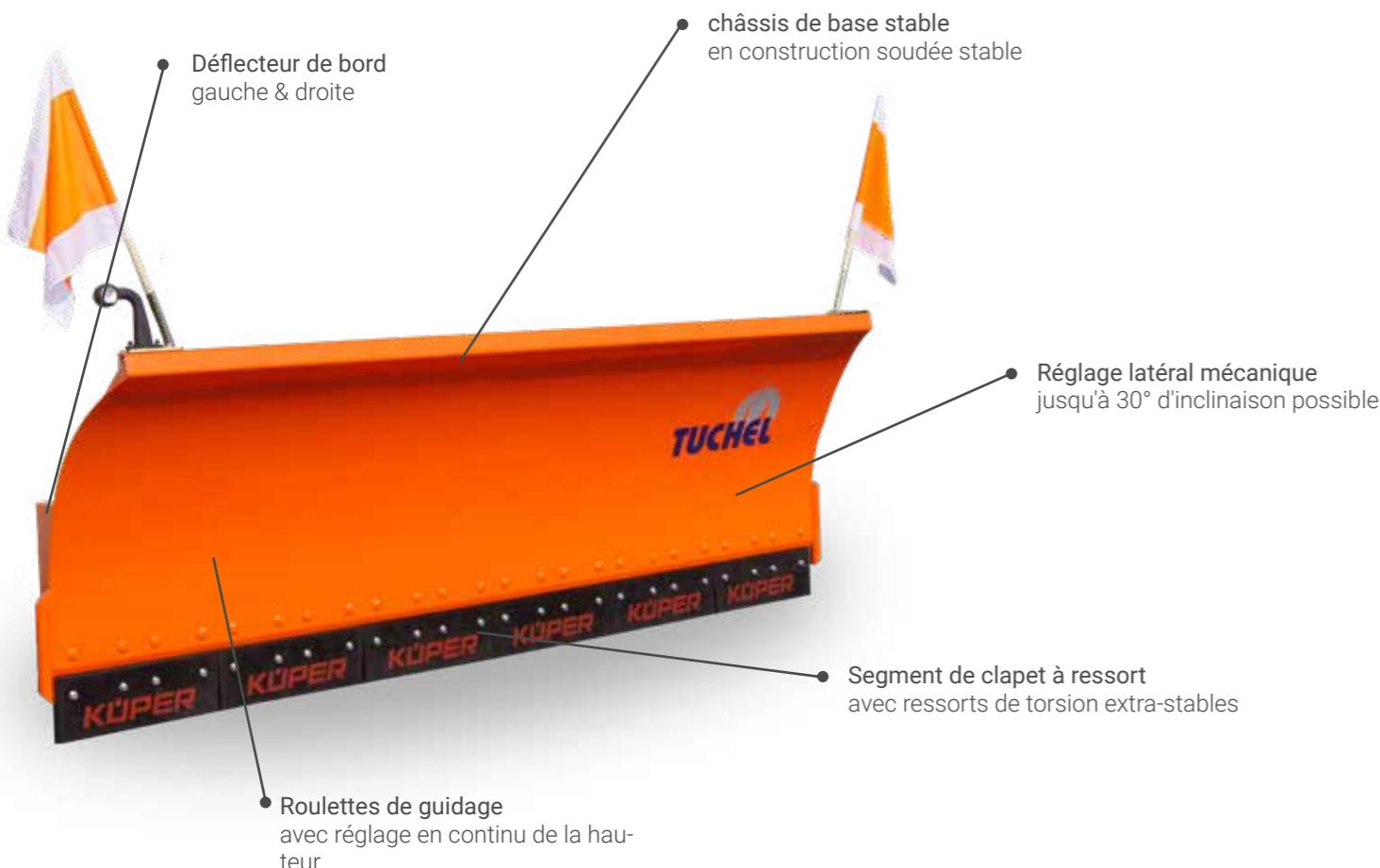
La lame chasse-neige robuste SF résiste aux conditions climatiques les plus rudes et peut être montée devant les chargeuses sur pneus, les tracteurs et les Unimogs.
