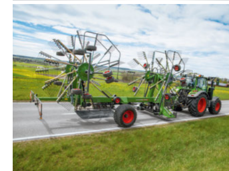
Die großvolumige Bereifung des Liftachse gewährleistet ebenfalls eine reduzierten Bodendruck.
