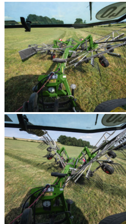
Die serienmäßige Folgesteuerung gewährleistet perfekte Schwade am Vorgewende sowie Feldrändern und -spitzen
