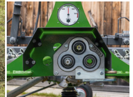
Universalgetriebe aus Leichtmetallguss für den Front- und Heckbetrieb.
