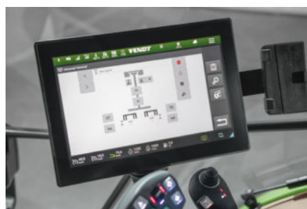
ISOBUS UT: Bedienmasken können auf Traktorterminal übergeben werden ISOBUS AUX-N: Fahrhebelübergabe ist möglich
