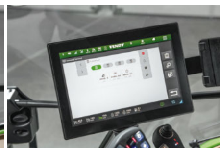
ISOBUS UT: Bedienmasken können auf Traktorterminal übergeben werden ISOBUS AUX-N: Fahrhebelübergabe ist möglich
