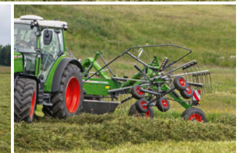
Das Schwadtuch klappt automatisch bei Vorgewende- oder Transportstellung nach oben.
