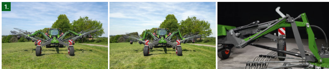
Schwad-/Arbeitsbreitenverstellung serienmäßig hydraulisch und bei PRO-Modellen per ISOBUS
