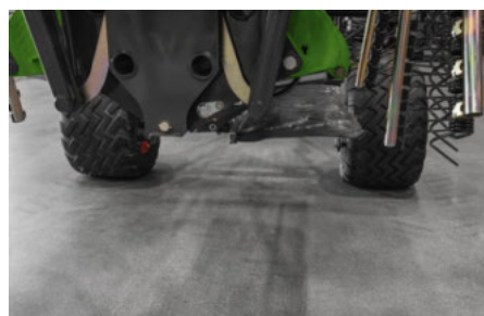
Der optionale hydraulische Schwadformer klappt automatisch beim Ausheben der Kreisel und erleichtert das Queren hoher Schwade sowie den Transport auf unebenen Feldwegen.
