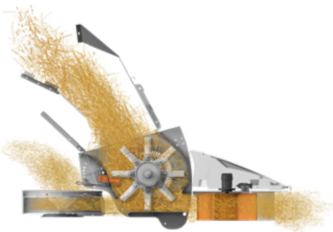
ShortCut-Häcksler - kraftvolle Verteilung und einfache Anpassung
