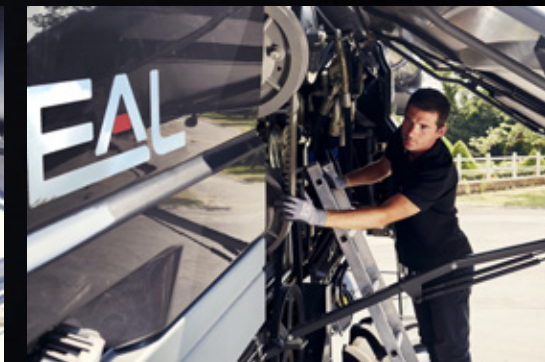
Tragbare Leiter für leichteren Zugang rund um die Maschine
