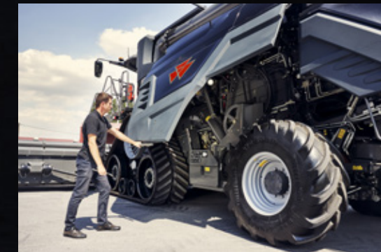
Schnell und bequem zu handhaben bei Wartungsarbeiten - einteilige Seitenabdeckungen
