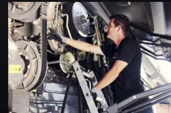
Vereinfachter Antriebsstrang, weniger Riemen und Ketten
