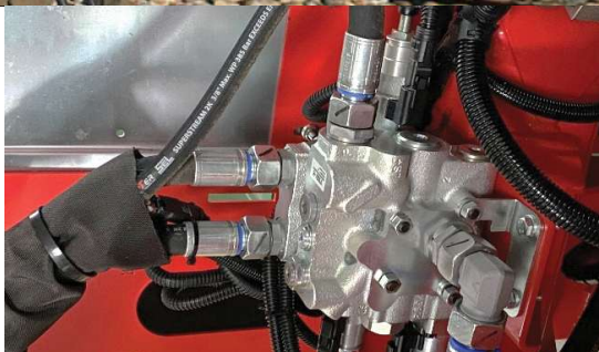
Das Bandventil bestimmt die Ablagerichtung und die Bandgeschwindigkeit – beides über das Terminal einstellbar
