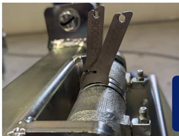
Einstellwerkzeug Kurbeltrieb (in Service-Kit enthalten)
