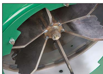
Dual-Shredding-System mit Piranha-Messer
