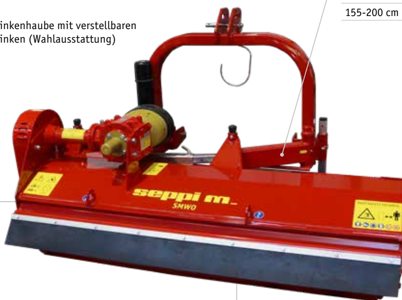
Einstellbare Haube zum Bestimmen des Zerkleinerungsgrades
