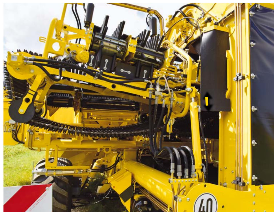
Serienmäßig: Automatischer Neigungsausgleich Igel 1 und Igel 2
