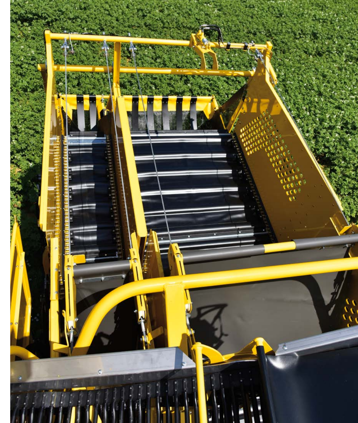
Geteilter Bunker mit Tuchrollboden für eine schonende Befüllung. Die Bunkerbefüllautomatik entlastet den Fahrer und sorgt für eine bestmögliche Ausnutzung des Bunkervolumens
