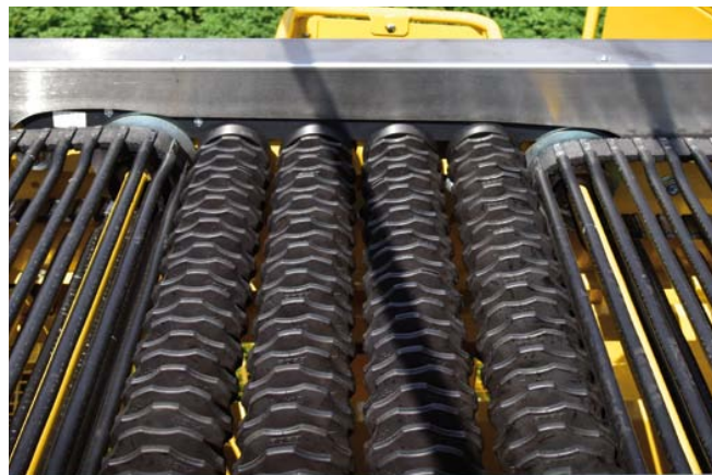
Sortierwalzen, stufenlos verstellbar von 25 bis 40 mm
