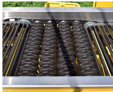
4 stufenlos verstellbaren Sortierwalzen
