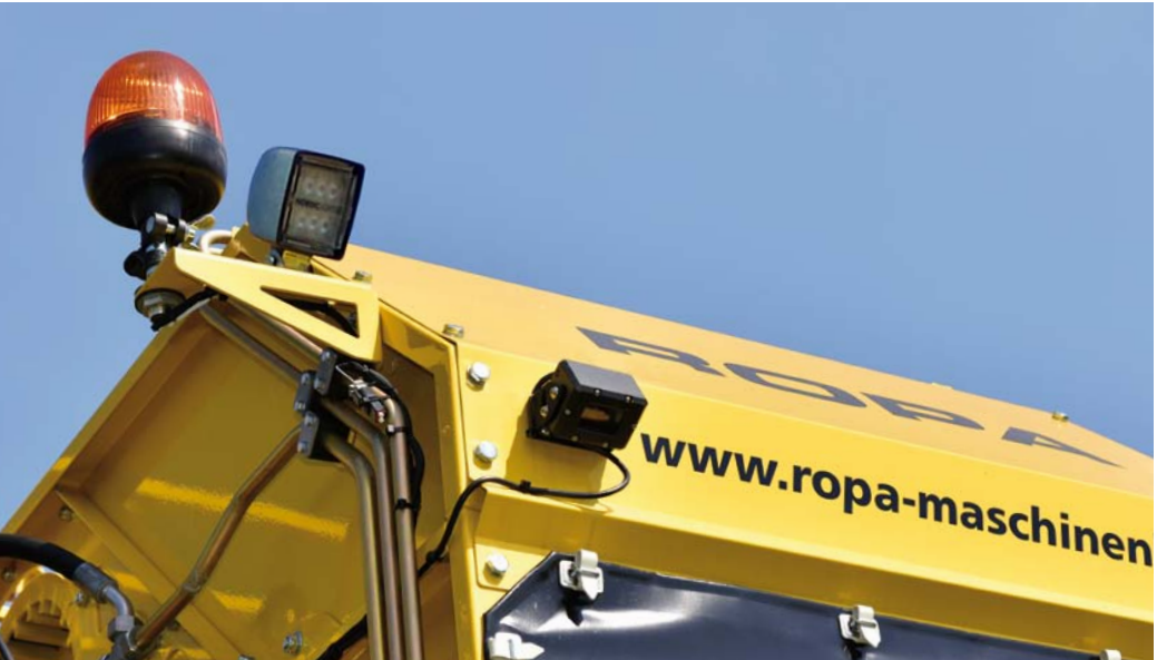
Rückfahrkamera am Heck, Rundumleuchte
