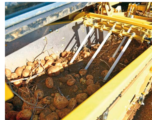
Rührwerk zur besseren Trennung von Kartoffeln und Kraut
