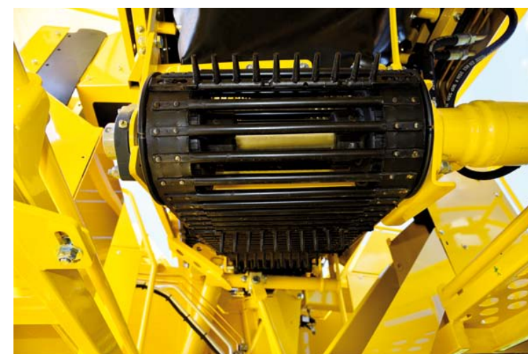
Perfekt integriertes Zuführband für eine optimale Befüllung des separaten Bunkers
