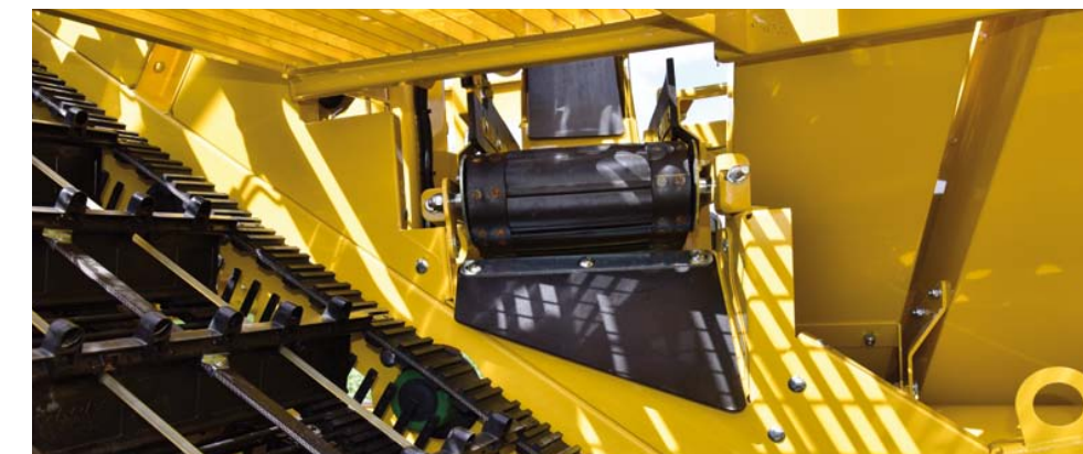
Beimengenrückführband auf Siebkette 2
