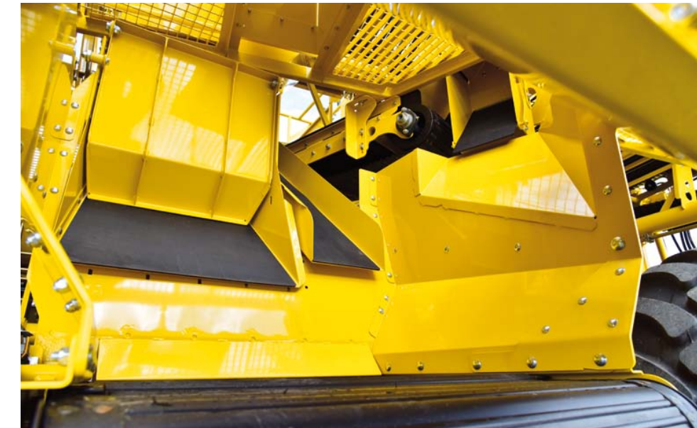
Beimengenrückführung kombinierbar nach Wunsch: - auf Boden - auf Beimengenrückführband - auf Sammelkasten-Austrageband
