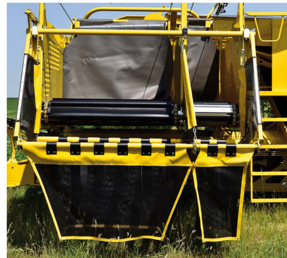
Geteilter Bunker mit Tuchrollboden für eine schonende Befüllung. Die Bunkerbefüllautomatik entlastet den Fahrer und sorgt für eine bestmögliche Ausnutzung des Bunkervolumens
