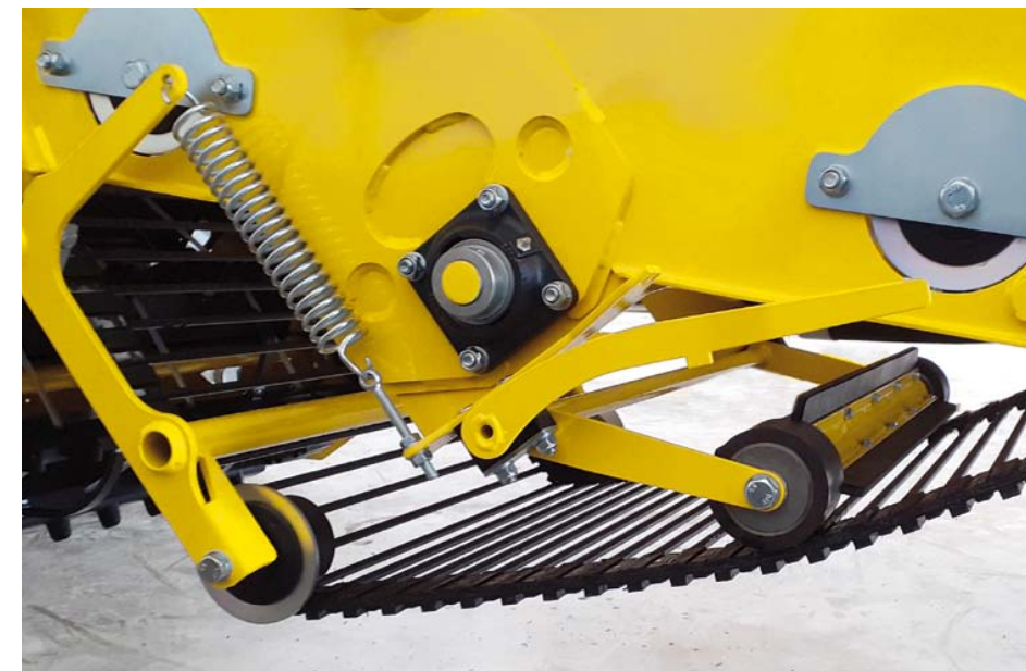
Siebkettenspanner mit integrierter Reinigungswalze
