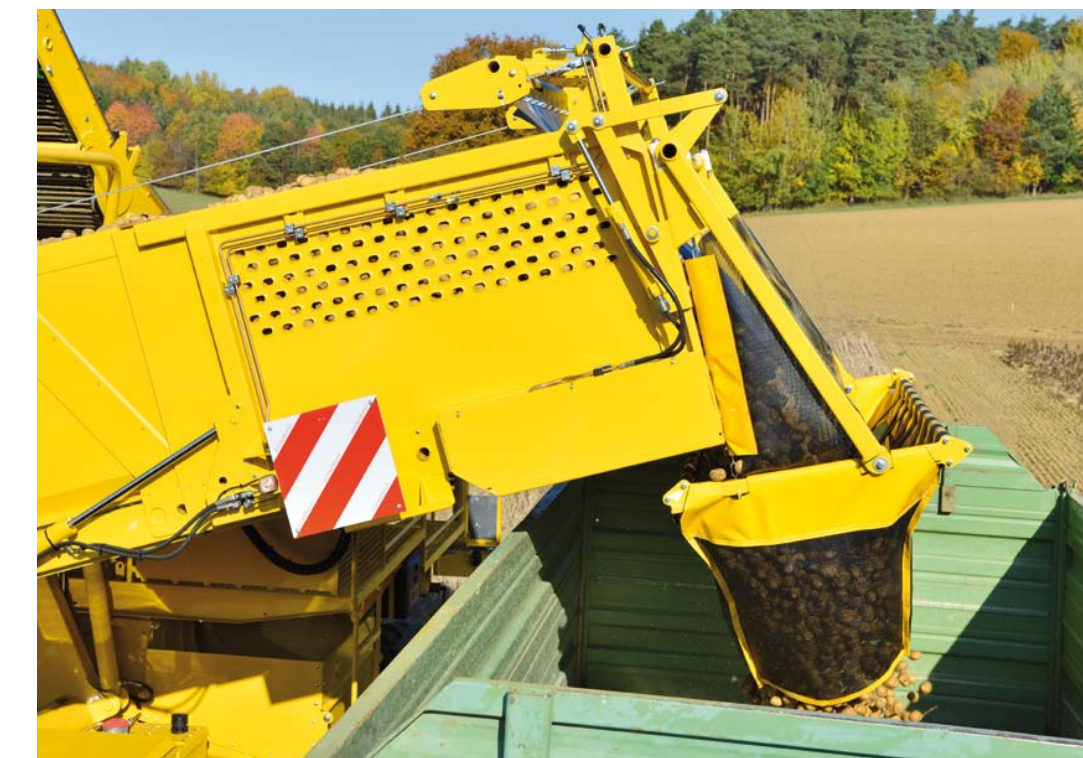
Silver Edition mit Big-Bag Vorrichtung für 900 mm Kistenfüller (optional)
