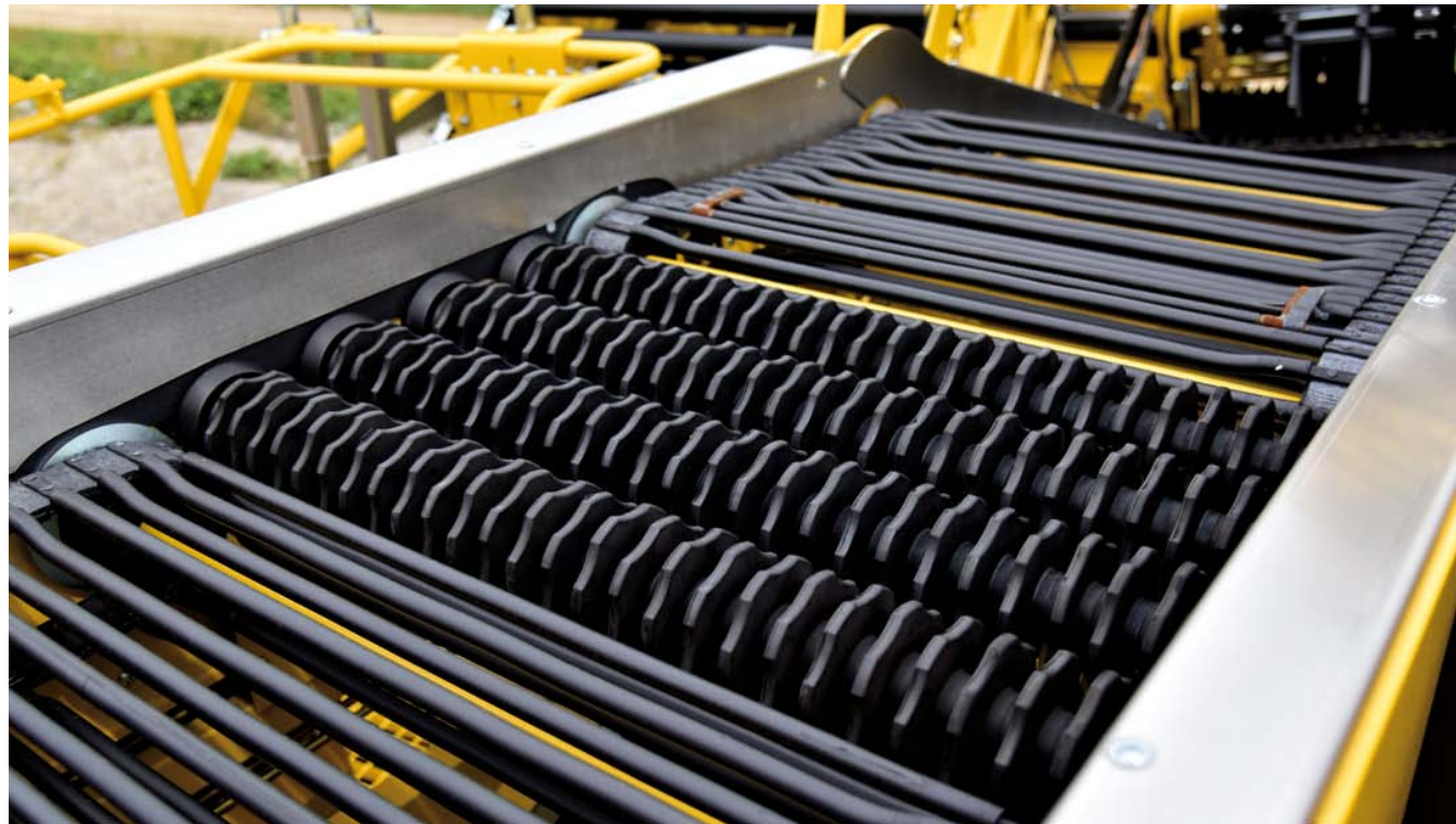
Sortierwalzen, stufenlos verstellbar von 25 bis 40 mm
