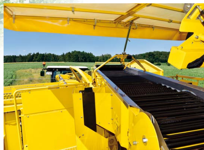
Geteilte Abwurfschächte und fünf stufenlos verstellbare Sortierwalzen ermöglichen das mühelose Aussortieren von Untergrößen in den separaten Bunker
