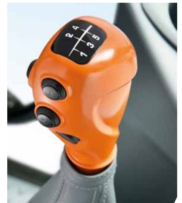
Gangschalthebel mit Kupplungstasten Comfort-Clutch und Powershift
