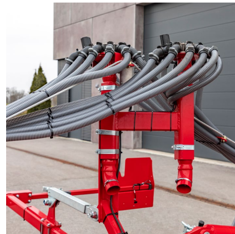
Abschaltung eines Verteilerturms und damit jeder zweiten Säreihe möglich
