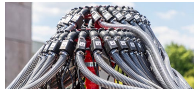
Dünger- und Saatflusskontrolle – für eine lückenlose Überwachung der Saat- und Düngerschläuche
