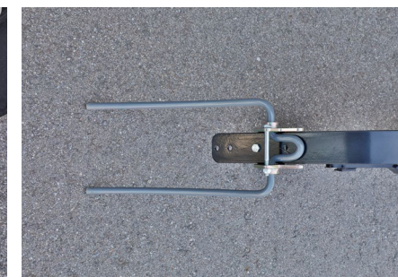
Der gerade Striegel – TurboDisc-Säschar wird für eine effizientere Bodenbearbeitung einzelschargen geführt
