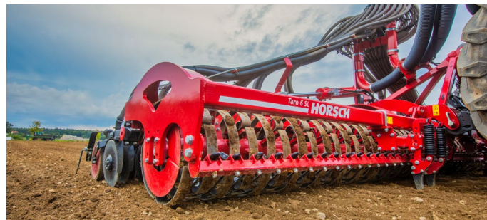
RollFlex Packer: tiefgehende Rückverfestigung, Zertrümmern von Kluten
