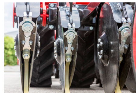
Der bewegliche Abstreifer garantiert eine hohe Selbstreinigung unter feuchten Bedingungen
