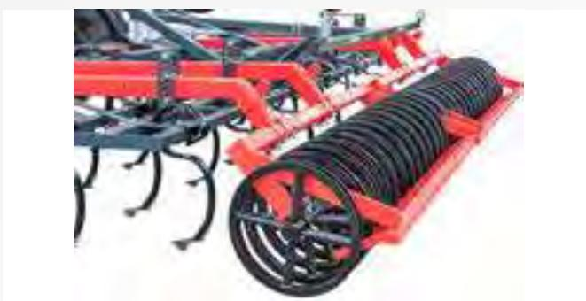
Die U-Profilringwalze bietet mit einem Durchmesser von Ø 540 mm ein breites Einsatzspektrum und kann vielseitig eingesetzt werden. Der U-Profilring nimmt Erde auf und verfestigt somit im „Boden zu Boden“-Verfahren. Dadurch wird eine offenporige Bodenoberfläche hinterlassen.
