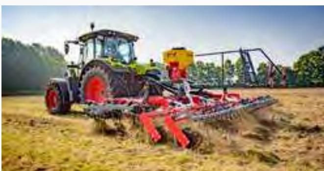
Zur Aussaat von Zwischenfrüchten stehen Kleinsamenstreuer mit 200 - 500 Litern Behältervolumen zur Verfügung. Mit 8 Pralltellern wird die Saat direkt vor der Nachlaufwalze gleichmäßig verteilt. Das Saatgut wird in den oberen 2-3 cm eingearbeitet. So wird ein gleichmäßiger Feldaufgang realisiert.
