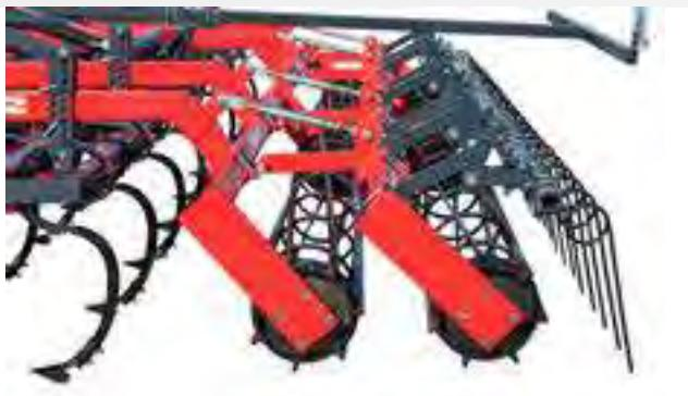
Die Doppelkrümmerwalze besteht aus zwei Krümmerwalzen mit Ø 350 mm. Sie sind zur Saatbettbereitung und mech. Unkrautbekämpfung auf mittleren bis schweren Böden vorgesehen. Durch die Schlagleisten werden die Wurzelballen von Erde befreit. Da die Rückverfestigung dieser Walze gering ist, können die Unkräuter durch einen nachfolgenden Striegel an die Oberfläche befördert werden. Der Bodendruck der hinteren Walze kann über verstellbare Spindeln eingestellt werden (optimal ca. 40% vorne / 60% hinten)
