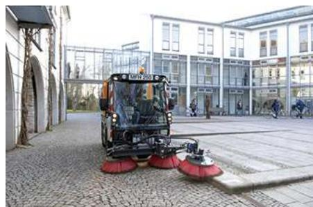
Die zuschaltbare Allradlenkung macht extrem enge Wendemanöver möglich. Die Allradlenkung wird hierbei mittels Lenkwinkelsensoren überwacht, was ein automatisches Zentrieren ermöglicht – anwenderfreundlich und sicher. Standardmäßig ist ein hydraulisches Zweikreisbremssystem mit Scheibenbremsen an Vorder- und Hinterachse verbaut.
