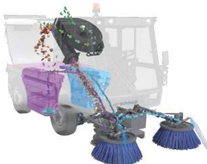
Das 2-Besensystem garantiert mit unabhängig voneinander steuerbaren Tellerbesen absolute Beweglichkeit in jeder Kehrsituation. Zwei stabile Besenarme mit integrierten Anfahruppern ermöglichen Kehrbreiten bis zu 2.900 mm.
