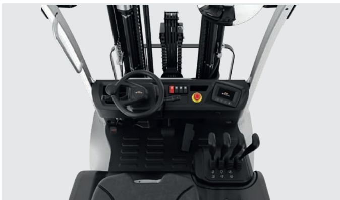
Flexibel und komfortabel: Fahrersitz und Lenksäule lassen sich stufenlos verstellen, sodass der Arbeitsplatz schnell und einfach auf unterschiedlich große Fahrer und Fahrerinnen angepasst werden kann
