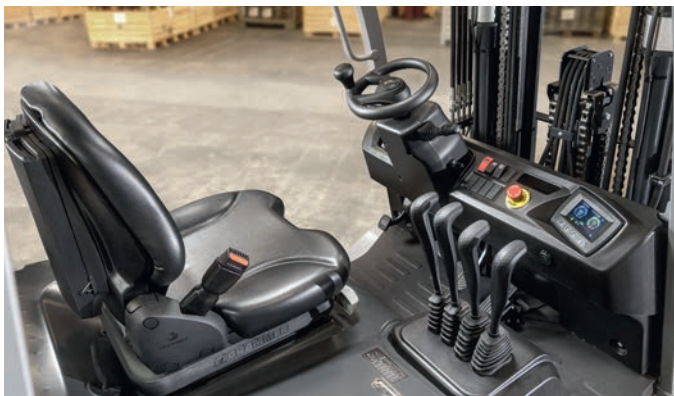
Smart mitgedacht: Die Elemente der STILL Hydraulikbedienung sind so angeordnet, dass sie auch mit Arbeitshandschuhen bequem zu nutzen ist
