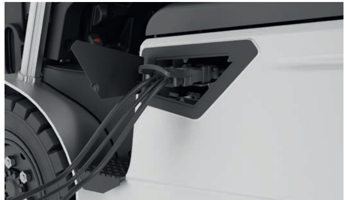
Laden leicht gemacht: Die wartungsfreie Lithium-Ionen-Variante mit seitlichem Schnellladezugang
