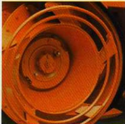
Die elastisch gelagerte Brechbolzenkupplung ist bei beiden Frästrommeln leicht zugänglich. Bei einer Überbeanspruchung brechen je Trommel zwei Messing-Bolzen, wodurch der Antrieb von der Fräswelle auf die Trommeln unterbrochen wird.
