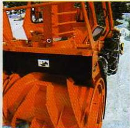
Alle nötigen SUVA-Schutzeinrichtungen, wie Haltestangen, Kabinenbügel, doppelte Abweisringe und Stöpsel mit Halterung, sind am Frässystem montiert.
