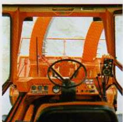
Der bequeme Arbeitsplatz mit günstigen Sichtverhältnissen auf das Frässystem, nach beiden Seiten und nach hinten. Annähernd Rundumsicht (343°). Fahrersitz hydraulisch gefedert. Beifahrersitz klappbar.
