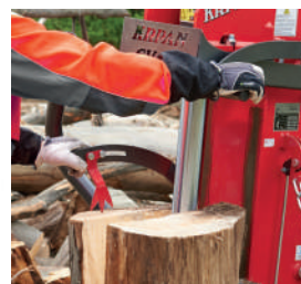
Linke Bedienungshebel mit integrierter Spaltgutfixierung
