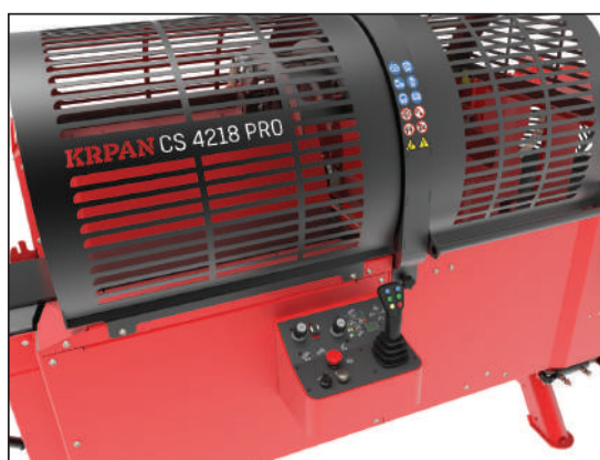
KR PAN CS 4218 PRO mit Joystick gesteuert alle Bewegungen der einzelnen Aggregate werden elektrohydraulisch ausgeführt, bis auf die Einstellung der Brennholzlängenbegrenzung.
