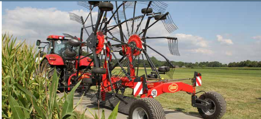
Eine Arbeitsbreite von 9,00 m und eine Transporthöhe unter 4,00 m wird erreicht ohne die Zinken zu entfernen.
