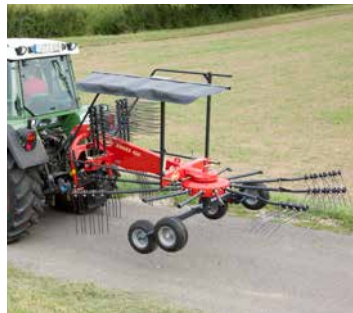
Um die Transport-/Unterstellbreite zu reduzieren, lassen sich bei allen Einkreiselschwadern die Zinkenarme abnehmen und die Schutzbügel nach oben klappen.
