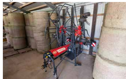
Niedrige Abstellhöhe trotz aufgesteckter Zinken.
