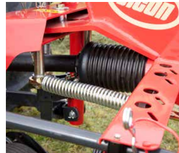
Der Dreipunkt-Nachlaufbock hat einen extrem großen Schwenkbereich und ermöglicht so ein optimales Nachlaufverhalten, auch in engen Kurven.
