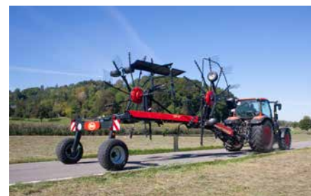
Transporthöhe unter 4 m mit aufgesteckten Zinkenarmen.
