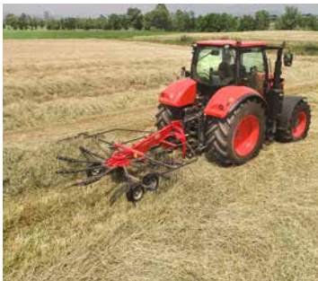
AnDEX 353 besitzt eine Arbeitsbreite von 3,50 m und 10 abnehmbare Zinkenarme.
