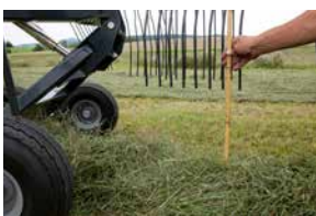
50 cm Aushubhöhe am Vorgewende. Große Schwaden können somit problemlos überfahren werden.
