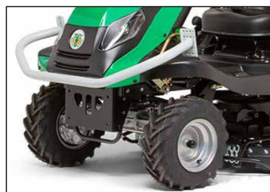
AS-Bereifung vorne: 6x6.50-8, hinten: 20x10.00-8
