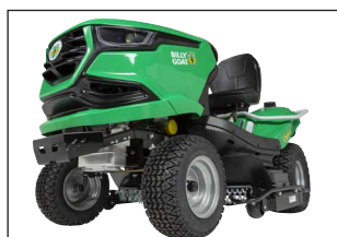
Rasenbereifung vorne: 16x6.50-8, hinten: 20x10.00-8
