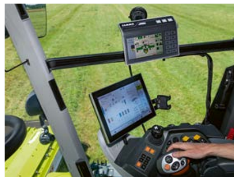
Komfortable Bedienung, zum Beispiel über verschiedene ISOBUS-Terminals und die ISOBUS-Funktionstasten des Fahrhebels.
