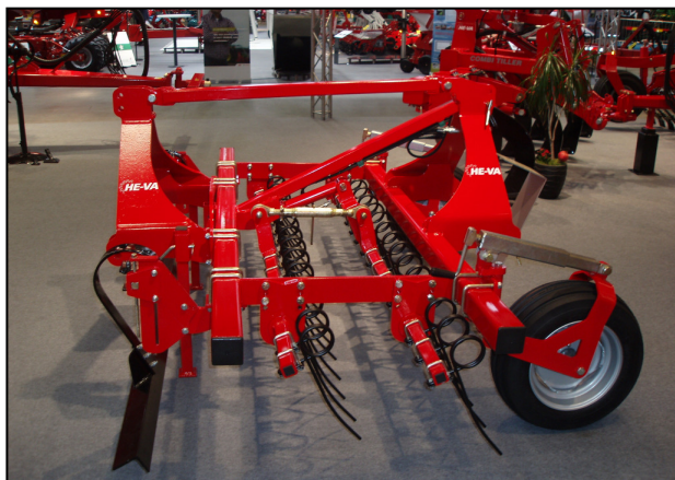
3,00 m Stroh-Striegel / Front-Strigle, 2 Zinkenträger mit 12 mm Zinken, Planierschiene und mit Dreipunktbau – vorn und hinter Montierung.
