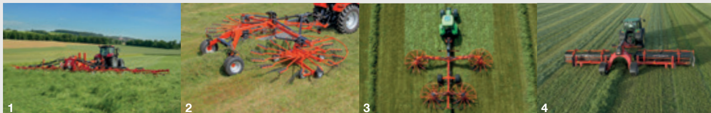
1. Giroheuer bis 17 m - 2. Aufgesattelte Zweikreisel-Schwader. - 3. Vierkreisel-Schwader. - 4. Bandschwader bis 13 m.
