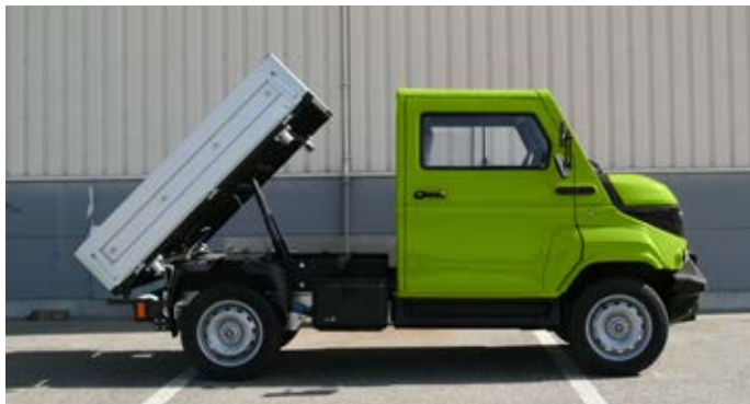
Dreiseitenkipper Entladen von Schüttgut und Platz für zwei Europaletten. Kippbar um 42° nach links und rechts, 37° nach hinten.
