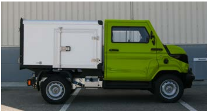
Koffer Solide Sache: die Box. Die Türen sind um 270° (Rückseite) und 180° (Beifahrerseite) schwenkbar und im geöffneten Zustand fixierbar.
