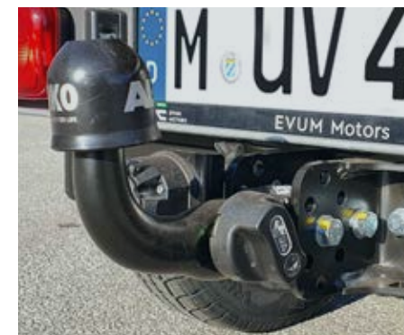
Abnehmbare Anhängerkupplung Gebremst 1.000 kg / ungebremst 750 kg / 70 kg Stützlast.
