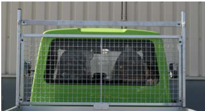
Aufprallschutzgitter Schutz von Fahrgastzelle und Heckfenster beim Transport von Langgut.
