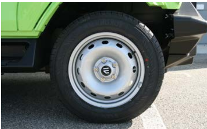
Sommer-, Winter- und Ganzjahreskomplettträder 185/75R16C, Felge: 6Jx16 Stahlfelge (alle Räder schneekettentauglich)
