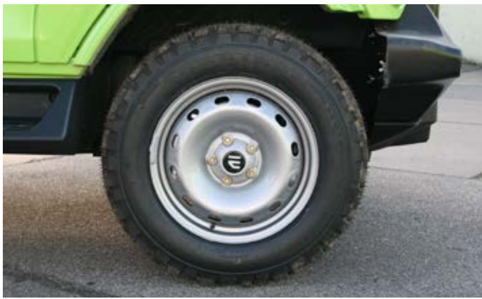
Geländekomplettträder 185/75R16C, Felge: 6Jx16 Stahlfelge
