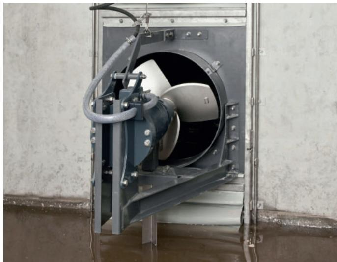
Le modèle stationnaire et réglable en hauteur convient pour les systèmes de canaux et de slalom. Le brasseur est monté directement sur la paroi transversale avec une ouverture de 800 mm. Le moteur immergé est disponible soit en acier inox avec une puissance de 20 CV (15 kW) ou en fonte grise avec une puissance de 20 CV (15 kW).
