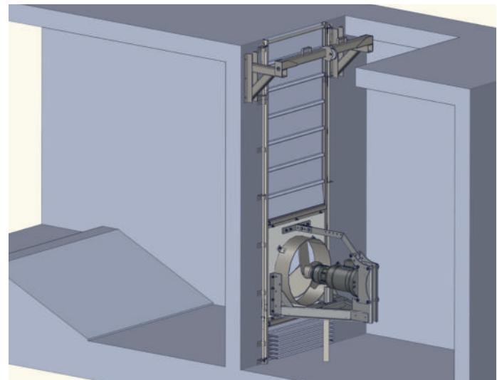
Le brasseur peut être installé dans des fosses d'une profondeur maximale de 4 mètres. Le treuil permet d'ajuster la hauteur d'immersion du brasseur. Le treuil est galvanisé et équipé d'un câble en acier inoxydable.
