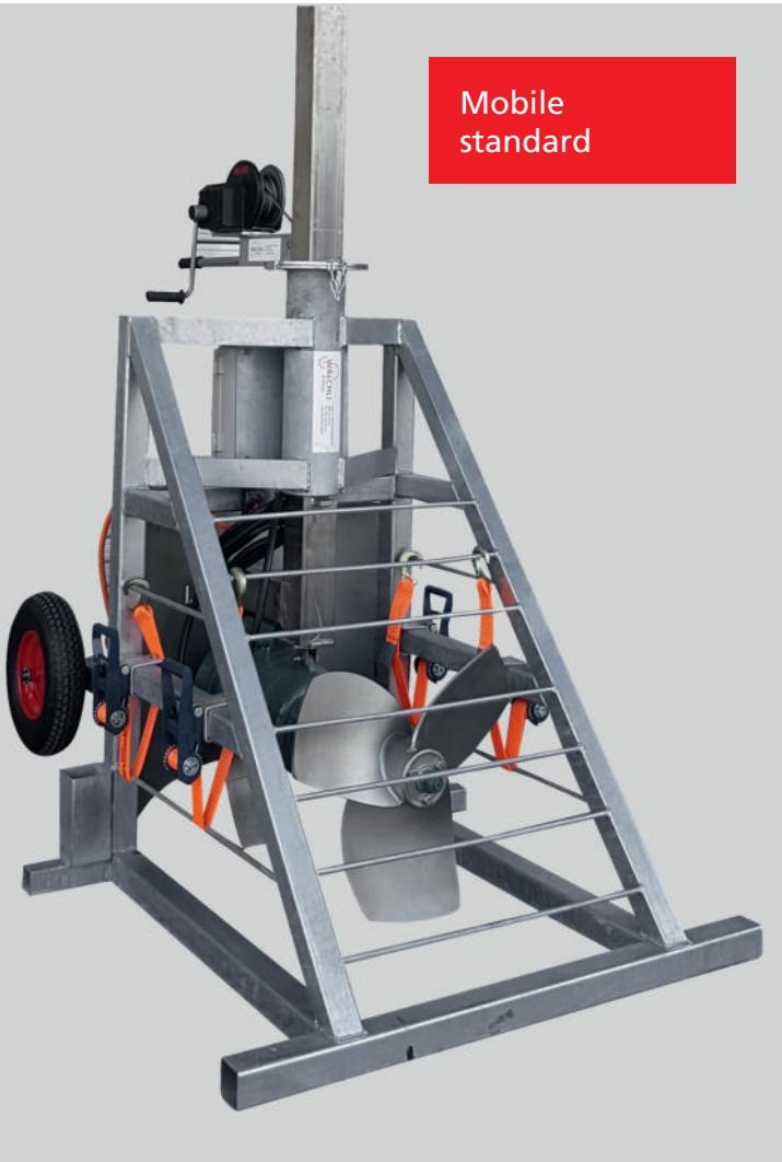
Les brasseurs immergés sont des brasseurs électriques, puissants et très efficaces, destinés à l'agriculture, biogaz et aux installations d'épuration. Ces brasseurs conviennent à tous les formes de fosses. Le moteur est équipé de capteurs thermos moulés (thermistance PTC) dans le bobinage. Les brasseurs sont disponibles en fonte grise ou en acier inox. L'engrenage planétaire compact et silencieux est doté d'une triple étanchéité (garniture mécanique). L'hélice est fabriquée en acier inox.
