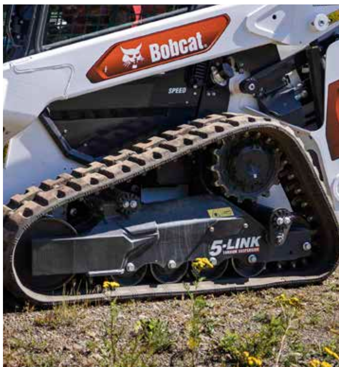
Système de suspension sur barres de torsion à 5 articulations
