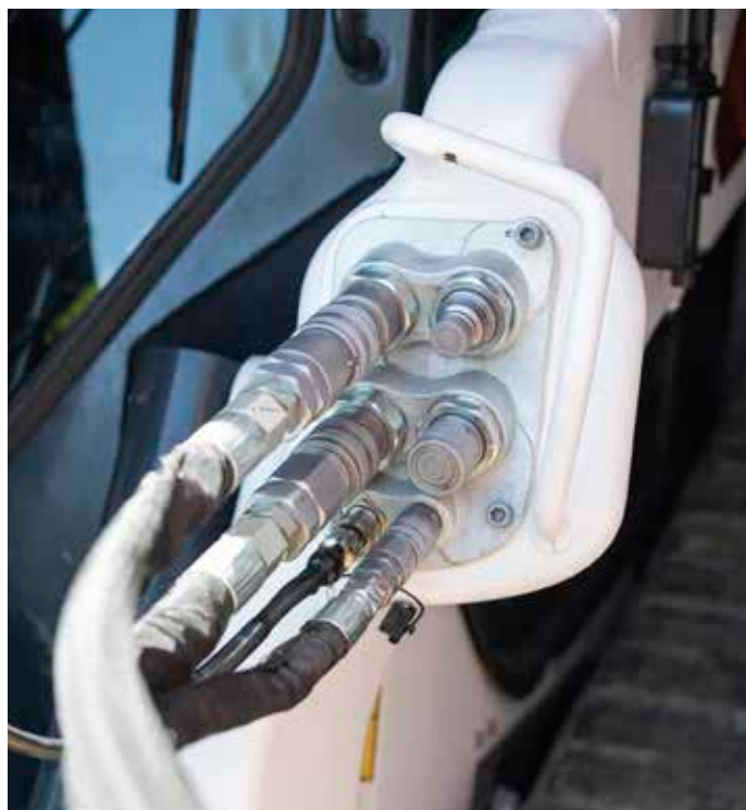
Bloc de connexion à 5 raccords pour la fonction Super Flow
