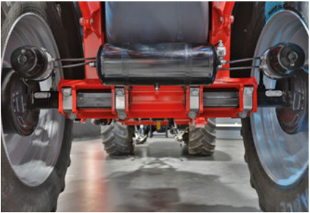
Steckachse für mechanische Verstellung der Spurweite je nach Bereifung von 1,50 bis 2,25 m
