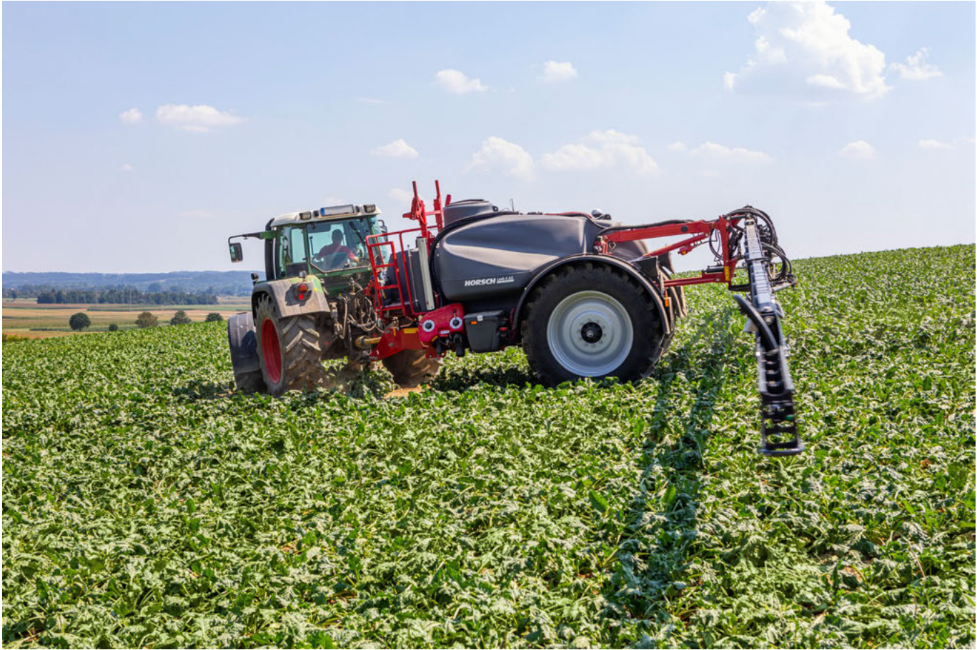
Deichsellenkung: Kulturschonung und spurtreuer Nachlauf in der Schlepperspur
