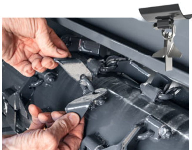
Werkzeugloser Umbau auf Vertikutieren – schnell gemacht
