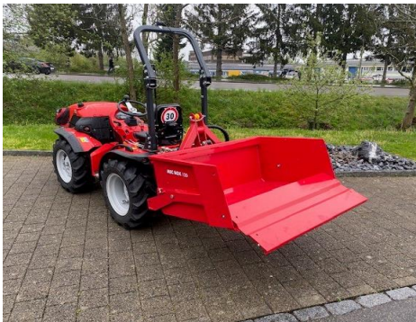
Kippschaufel MEC, 3-Punkt-Anbau, Kat I, Heckdeckel auf- oder abklappbar, mechanisch kippbar
