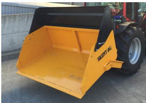
Kippschaufel RI, 3-Punkt-Anbau, Kat I, Heckdeckel aufklappbar, hydraulisch kippbar
