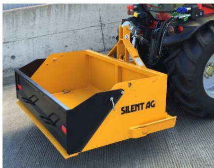
Kippschaufel RI, 3-Punkt-Anbau, Kat I, Heckdeckel aufklappbar, hydraulisch kippbar
