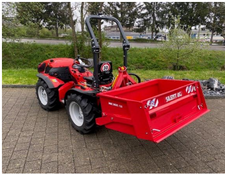
Kippschaufel MEC, 3-Punkt-Anbau, Kat I, Heckdeckel auf- oder abklappbar, mechanisch kippbar
