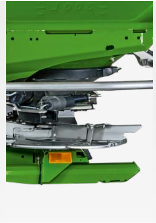
Abstellvorrichtung mit Kufe für Super- und Ultra-Rahmen
