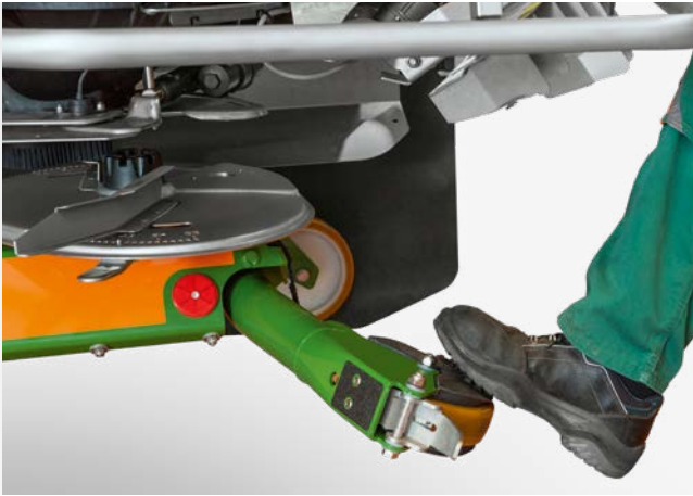
Roll- und Abstellvorrichtung für Super- und Ultra-Rahmen
