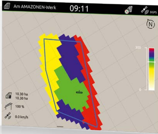
Darstellung der Applikationskarte im AmaTron 4
