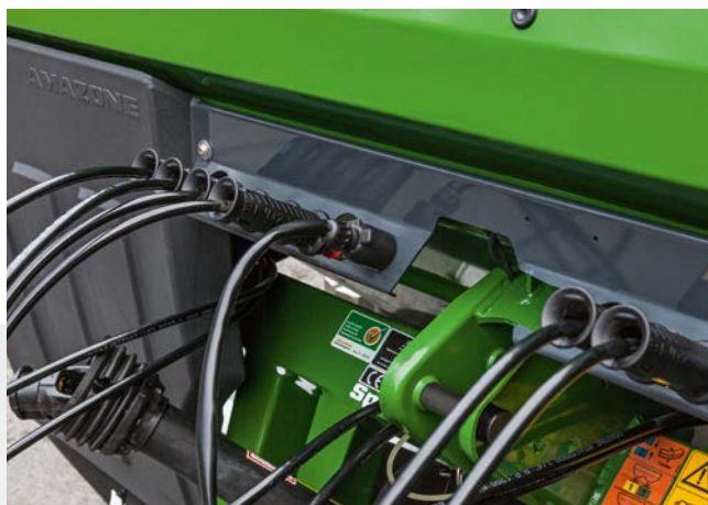
Übersichtliche Garderobe für Hydraulikschläuche
