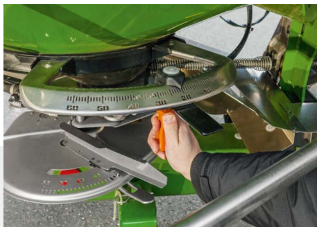
Einfaches Verstellen der Schieberkonsole mit großer Skala
