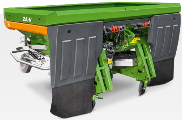
ZA-V 1400 mit Special-Rahmen für bis zu 2.200 kg Nutzlast
