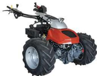
Der CC 150 wird von einem Zweizylinder-Benzinmotor mit **18 PS** angetrieben. Die kompakte Bauweise ermöglicht Arbeiten bei engen Verhältnissen aber auch den Anbau von grösseren Anbaugeräten, ohne Abstriche beim Leistungsbedarf machen zu müssen.
