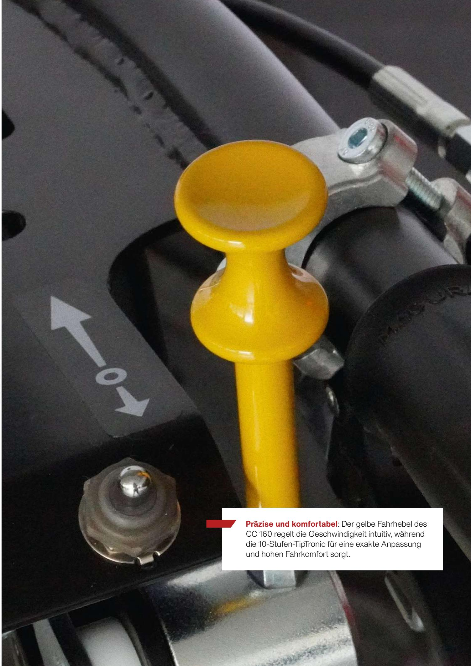
**Präzise und komfortabel:** Der gelbe Fahrhebel des CC 160 regelt die Geschwindigkeit intuitiv, während die 10-Stufen-TipTronic für eine exakte Anpassung und hohen Fahrkomfort sorgt.
