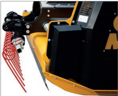
Die integrierten Striegel mit 16 Non-Stop Zinken dienen der Aufrichtung von ange-drückten Stoppeln vor dem Mulchgang und Erzeugung von Feinerde.
