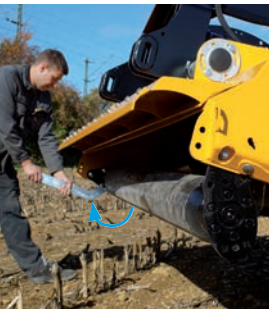
Langlöcher in Kat. 2 an den Ober- und Unterenkeranbaupunkten ermöglichen zusammen mit der Schwenk-Stützwalze eine sehr gute Boden Anpassung.
