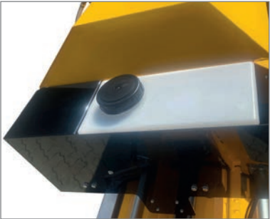
Integrierter Frischwassertank zum Spülen der Anlage.
