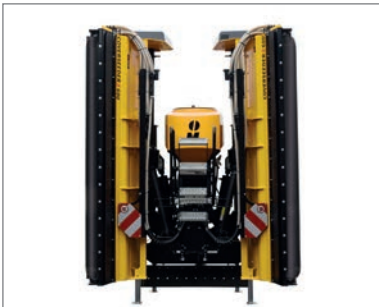
Klappung auf unter 3 m Transportbreite.
