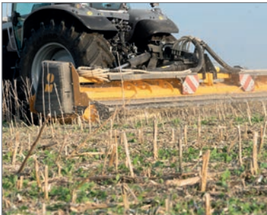
Soloeinsatz des Mulchgerätes durch leichte Demontage der Saateinrichtung möglich.
