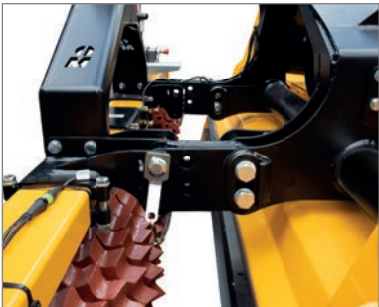
Die Walze und der Striegel sind durch einfache und schnelle (De-)Montage auch einzeln nutzbar. Soloeinsatz - kein Problem!
