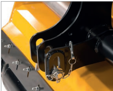
Langlöcher an den Ober- und Unterlenkeranbaupunkten ermöglichen zusammen mit der Schwenk-Stützwalze eine sehr gute Bodenadaptation.
