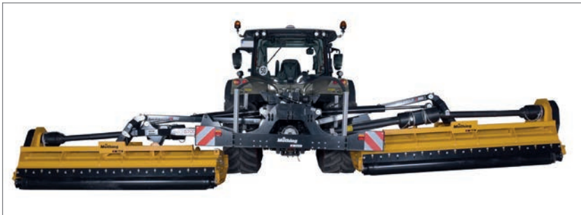
Die Mulchgehäuse lassen sich auch einzeln ausheben.
