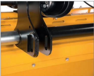
Einfaches Verstellen der Schwenk-Stützwalze, auch ohne zusätzliche Helfer.
