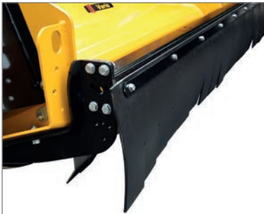
Erweiterte Abhalteeinrichtung bei extrem starkem Steinbesatz.
