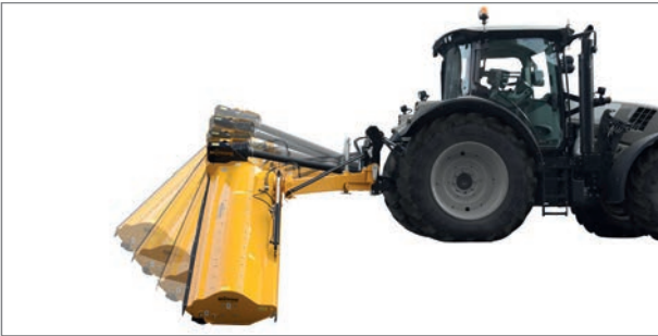
Mechanische, patentierte Anfahrssicherung löst zuverlässig aus und kehrt selbständig in die Arbeitsposition zurück.
