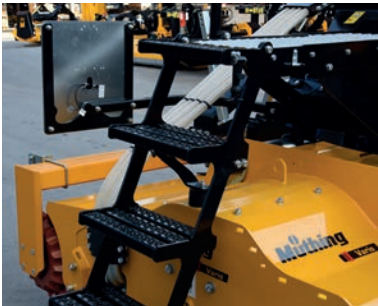
Einfaches Befüllen des Saattanks durch eine klappbare Trittstufe.
