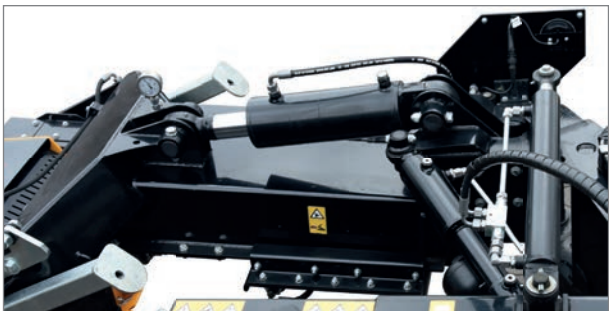
Hydropneumatische Auflagedruckentlastung für optimale Bodenanpassung.
