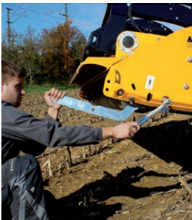
Langlöcher in Kat. 2 an den Ober- und Unterenkeranbaupunkten ermöglichen zusammen mit der Schwenk-Stützwalze eine sehr gute Boden Anpassung.
