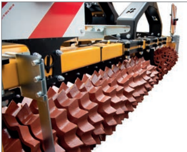
Die Prismenwalze mit 38 cm Durchmesser und dem bewährten „Schafstritte- Verdich-tungseffekt“ sorgt in Kombination mit der Feinerde für den perfekten Bodenschluss.
