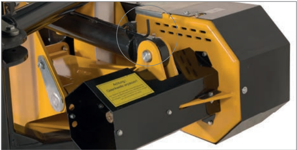
Gut zu erreichende Transportsicherung.
