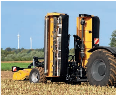
Die hydraulisch anpassbare Arbeits- und Transportposition sorgt für eine Transporthöhe von unter 4 m.
