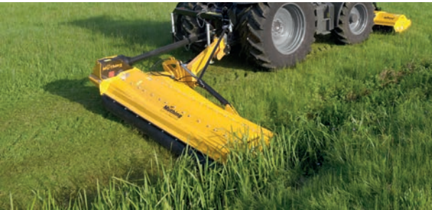
Viel Platz für den Anbau am Traktor und die mitschwenkende Gelenkwelle.
