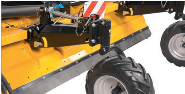
Mit dem Spannschloss stellen Sie schnell die richtige Schnitthöhe ein.
