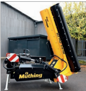
Dank durchdachter Bauweise lässt sich das Mulchgerät platzsparend zusammengeklappt abstellen.
