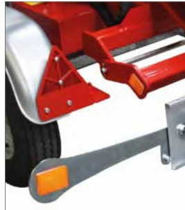
Breiterer Reflektorträger für mehr Sicherheit
