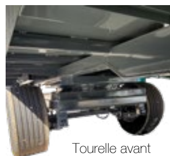
Plancher tôle 3 mm. Peinture polyuréthane
