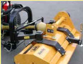
Déplacement lat. par parallélogramme
