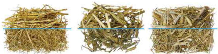
Abb. oben: Niedriger Zerkleinerungsgrad Abb. unten: Hoher Zerkleinerungsgrad
