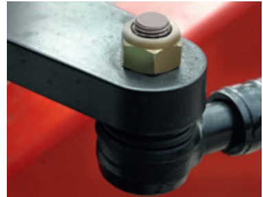
▲ Einstellbarer Lenkkopf der Spurstange
