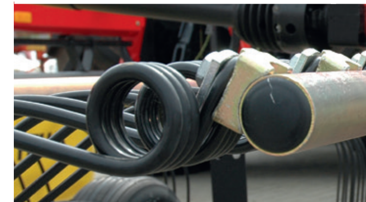
Vollkommen glatte Vorderkante der Zinkenarme
