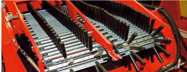
Typ UB: beste Trennergebnisse auf klutenreichen Böden mit geringem Steinbesatz
