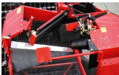
Typ NB mit 3. Igelband und 3. Abstreiferwalze – für noch mehr Leistung auf beimengenarmen Böden
