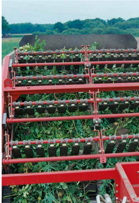
Optimale Produktschonung: Grobkrautband mit weichen PU-Mitnehmern (Abstände wahlweise 200 mm, 280 mm)
