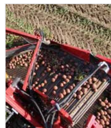
Typ NB mit 3. Igelband und 3. Abstreiferwalze – für noch mehr Leistung auf beimengenarmen Böden
