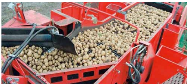
Typ NB: beste Trennergebnisse auf beimengenarmen Böden
