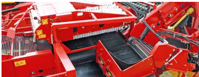
Typ SB: beste Trennergebnisse auf steinreichen Böden dank innovativem kinetischen Steintrenngerät
