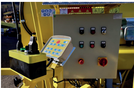
Die Bedienungseinrichtung der Stehplattform ist übersichtlich und individuell einstellbar. Bedienung der Lenkung über Joystick oder Lenkrad wählbar.
