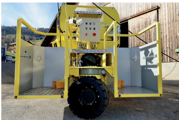
Grosszügige Stehplattform mit Sicherheitspedal, je nach Austragsvariante Plattform beidseitig.
