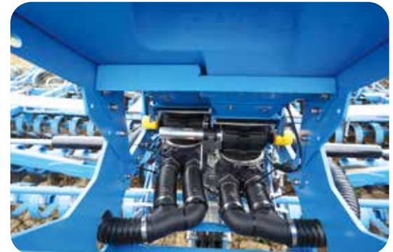
Für eine **exakte Querverteilung im Erdstrom** über die gesamte Arbeitsbreite – auch bei widrigen Wetterbedingungen – wird das Saatgut vom hydraulisch angetriebenen Gebläse zu den Verteilerköpfen der einzelnen Teilbreiten und anschließend zu den Pralltellern befördert.
