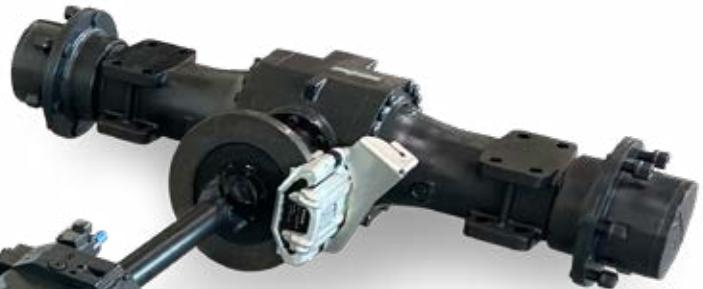
Dies wurde unter anderem möglich gemacht durch die **Dana Spicer** Achsenkonfiguration mit pendelnder Hinterachse. Diese kann sowohl hydrostatisch als auch elektrisch angetrieben werden. Die Pendelachsen sind bereits in schwereren Gewichtsklassen bekannt und werden jetzt einzigartig in unserem neuen Compact Loader angewendet.
