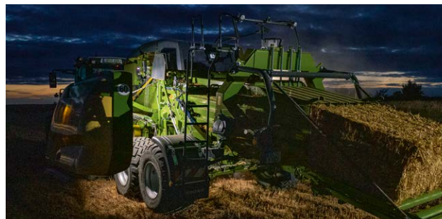
Éclairage derrière les boîtes à ficelle
