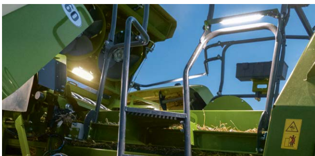
Éclairage de l'échelle d'accès
