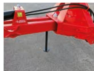
**Montage für hydraulischen Seiten-schub** Alle neuen GT-DK-Planierschilde sind für den Einbau eines hydraulischen Seitenschiebers (Art.-Nr 2528, vorbereitet.
