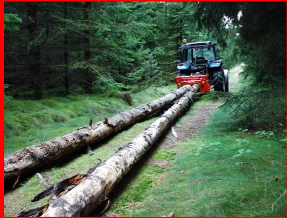
Le grappin manutentionnera facilement des billes de 20-30 m / 60/90 pi. Le cylindre de rotation du grappin doit être raccordé à une section flottante de l'ensemble vanne hydraulique du tracteur.
