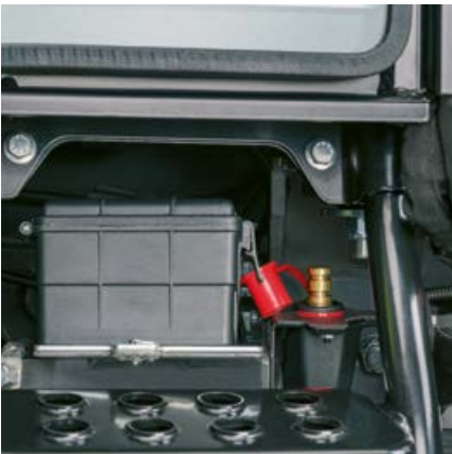
Der AXOS 2 erleichtert Ihnen den Alltag mit vielen intelligenten Lösungen wie z.B. versetzten Batteriepolen auf der rechten Kabinenseite.
