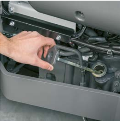
Ölstandskontrolle und Nachfüllen erfolgen bei geschlossener Haube an der rechten Seite des AXOS 2.
