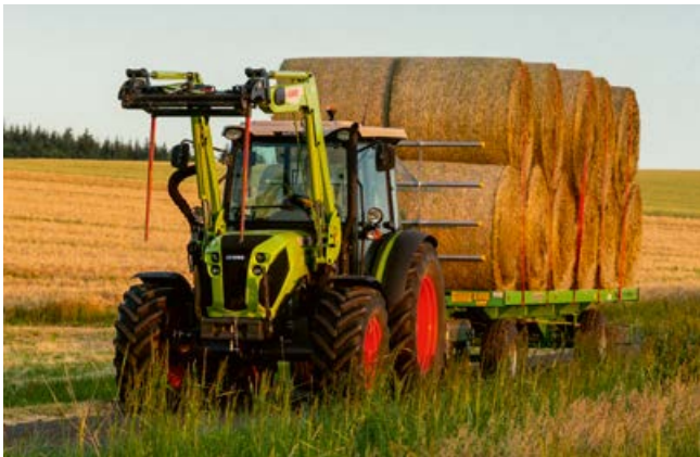
Durch das Konzept der Anbaukonsolen kann ein CLAAS Frontlader auch später noch problemlos nachgerüstet werden.
