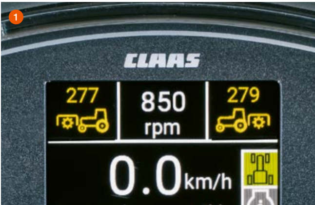
1 Dank der digitalen Drehzahlanzeige für Front- und Heckzapfwelle arbeiten Sie immer mit der passenden Drehzahl.
