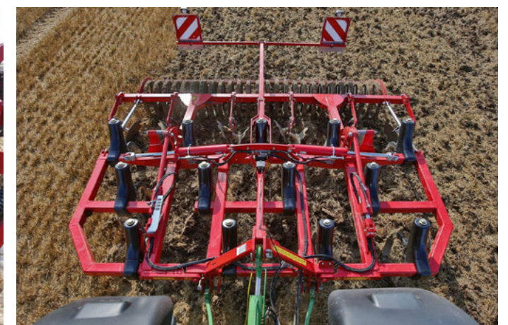
Gleichmäßige Zinkenaufteilung für idealen Erdflus
