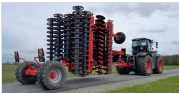
Suivi parfait du sol par le système GCS. Pression constante sur chacune des quatre sections.
