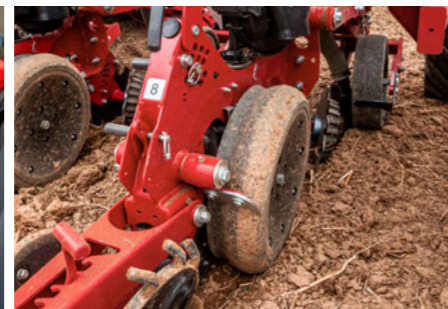
RID-Rad reduziert Bodenverdichtungen direkt am Säschlitz bei sehr harten oder Direktsaatbedingungen
