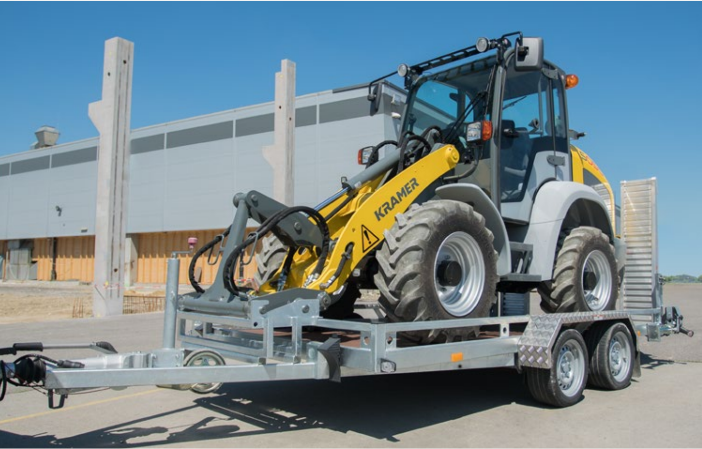
Einfache und schnelle Ladungssicherung durch Verriegelung der Kramer Schnellwechselaufnahme direkt am Anhänger.
