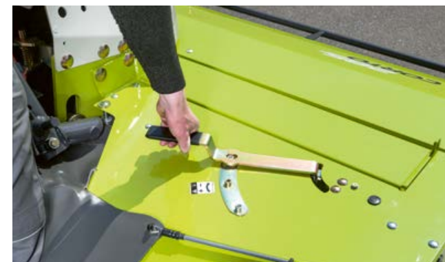
Schwadscheibenverstellung mit einem Handgriff.
