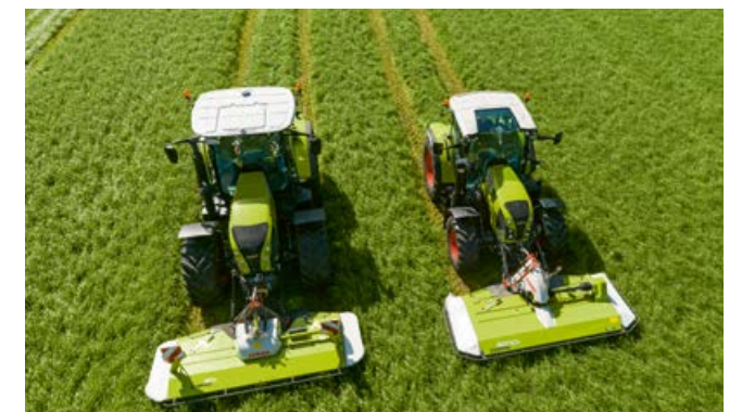
Schwadbreite mit einem oder zwei Schwadscheibenpaaren.
