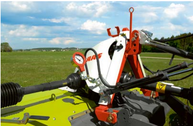
Optionale hydraulische Entlastung ACTIVE FLOAT für Frontmähwerke.
