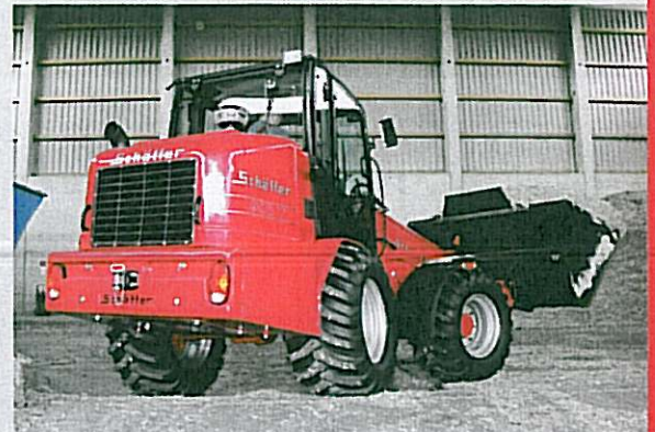
Essieu oscillant à l'arrière pour une stabilité optimale, également pour une position articulée.
